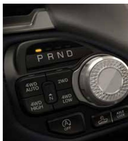
Ab der Ausstattungsvariante Big Horn verfügt er über den Auto-Modus, der das Drehmoment nur bei Bedarf auf die Vorderräder überträgt und so für minimalen Kraftstoffverbrauch und maximale Sicherheit sorgt.
